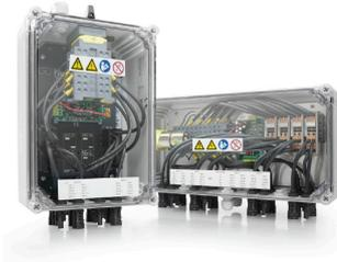
Per un arresto remoto sicuro I sistemi fotovoltaici sul tetto possono richiedere un dispositivo di disconnessione nel punto in cui i cavi entrano nell'edificio, che è collegato alla rete elettrica dell'edificio. Ciò consente ai vigili del fuoco di svolgere un lavoro in caso di emergenza senza essere inutilmente minacciati. Una volta ripristinata l'alimentazione, il PV Next Fireman Switch ricollega automaticamente le stringhe fotovoltaiche.
